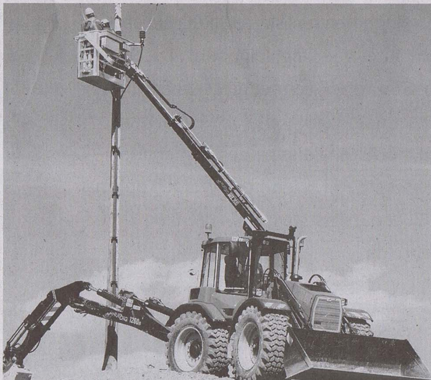
Drei Maschinen in einer: Huddig Volt integriert Bagger, Lader und Hubarbeitsbühne. Foto: econtech
